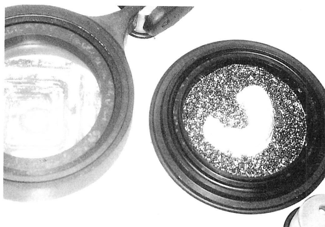
Fig. 2: Modelo colocado en la campana de presión
