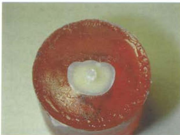
Fig. 2. Especimen con el composite listo para la prueba de adhesión.
