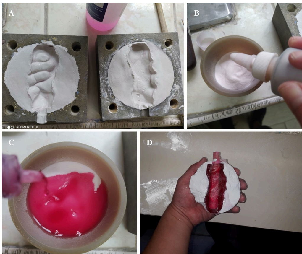
Fig. 4. A. Mufla y contramufla con sus diferentes registros. B y C. Preparación del acrílico rápido con monómero con la técnica de premezclado para colocarlo en la mufla. D. Rescate fuera del yeso del mango con acrílico polimerizado.
